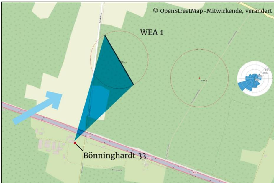
Abb. 36 Ausrichtung der geplanten WEA 1 zum Standort Bönninghardt 33 bei WSW-Wind (Hauptwindrichtung)
