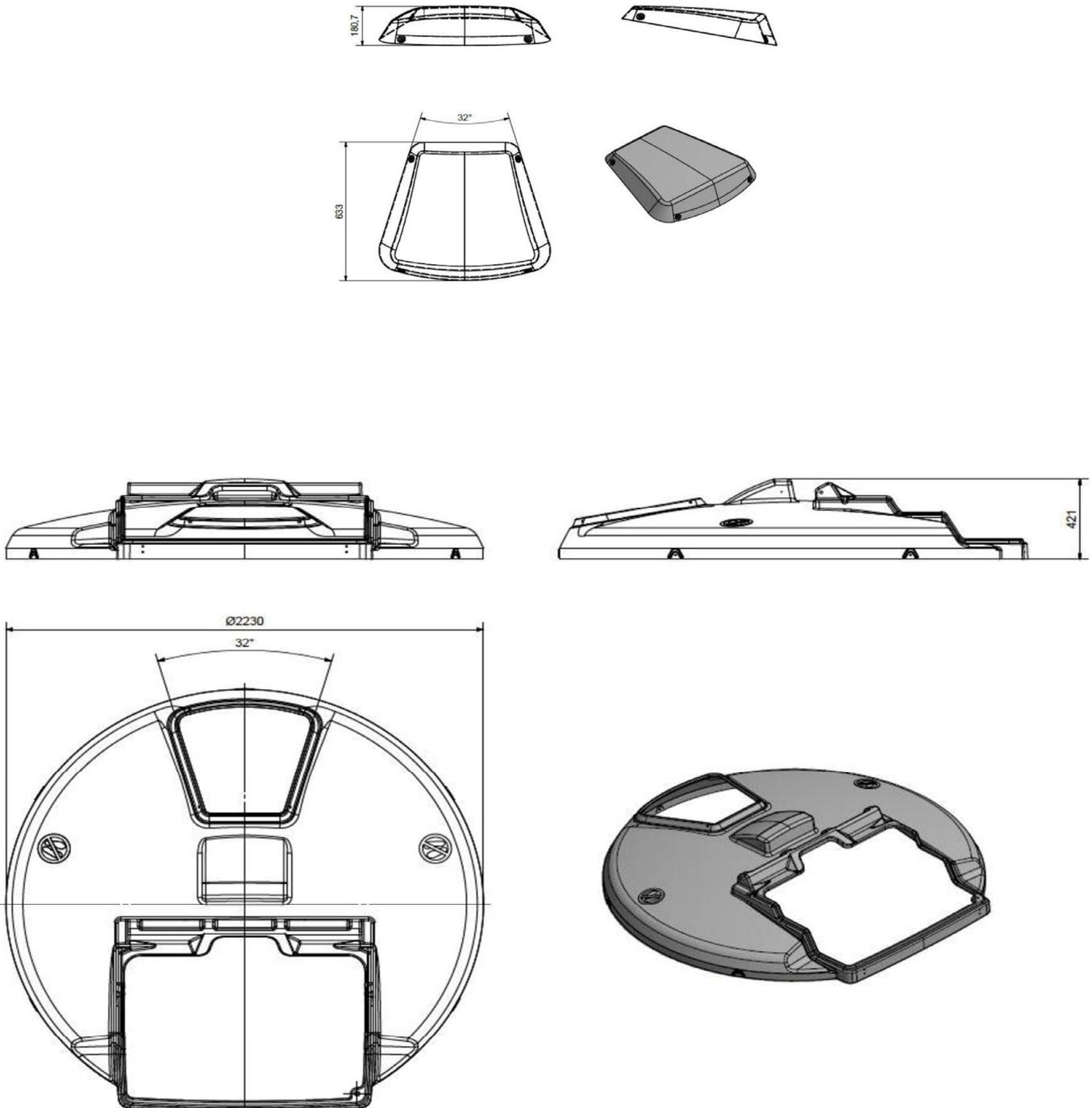
Rotationsgeformte Behälterkombination aus Polyethylen (PE)
