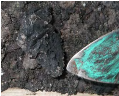
Abbildung 15: B2-15; 25,5 m bis 25,9 m; KW C10-C40: 44.000 mg/kg TS
