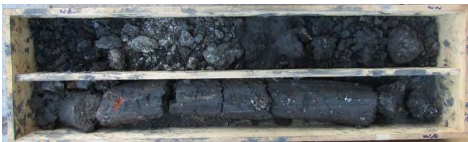
Abbildung 43: Oben: B3 - 34 m bis 35 m; Unten: B3 - 35 m bis 36 m; B3-18; 35,0 m bis 35,1 m – KW C10-C40: 1900 mg/kg TS;
