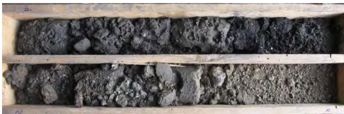
Abbildung 28: Oben: B3 - 4 m bis 5 m; Unten: B3 - 5 m bis 6 m; B3-3 – KW C10-C40: 3000 mg/kg TS
