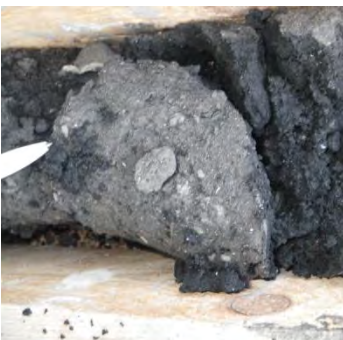
Abbildung 23: B2-6: 41,2 m bis 42,0 m; KW C10-C40: 3300 mg/kg TS
