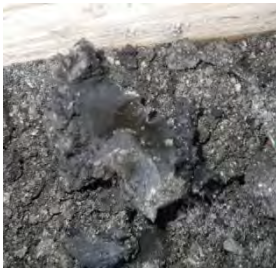
Abbildung 2: B2-24; 2,3 m bis 2,4 m; KW C10-C40: 340.000 mg/kg TS
