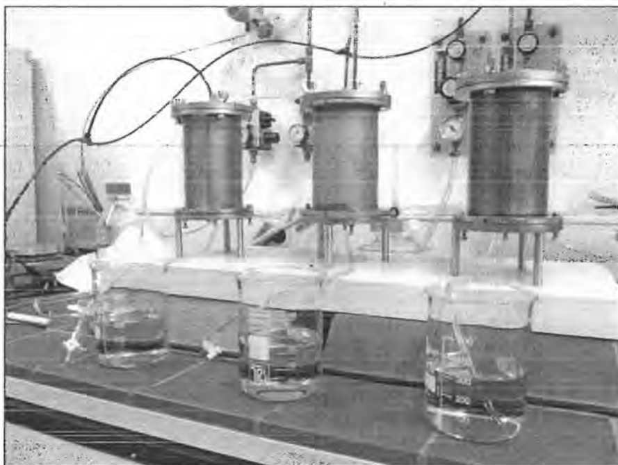
Abb. 2-1: Versuchsaufbau Bodensättigungsextrakt mit Probenahme
