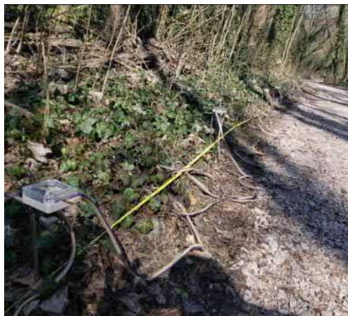
Abb. 1: zeigt eine 2D-Geoelektrik-Messlinie mit Spießen und Elektroden.
