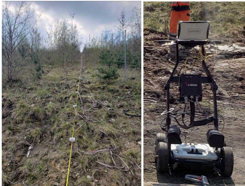
Abb. 1: links: Geoelektrik-Profilauslage an S3 mit den über Flachbandkabel verbundenen Elektroden auf Spießeln (Fa. LGM). rechts: Georadar Messsystem der Fa. IDS mit DF-Antenne der Frequenzen 200 MHz und 600 MHz.
