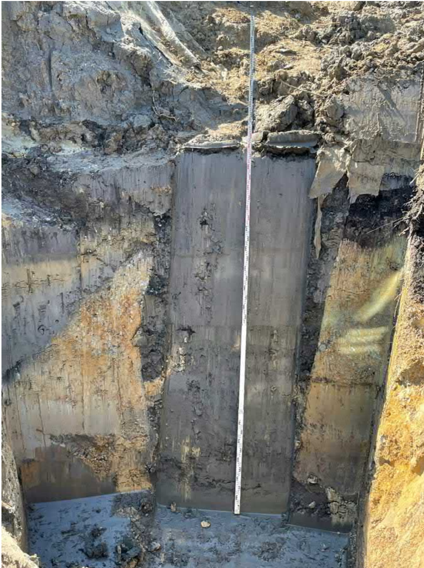
Abb. 6: Schurf 6 (vertieft) Aufnahme des Schurfs am 08.07.2021 Tonkeil; links Verfüllung Grubenrand auf anstehendem Geschiebelehm, rechts Geschiebelehm
