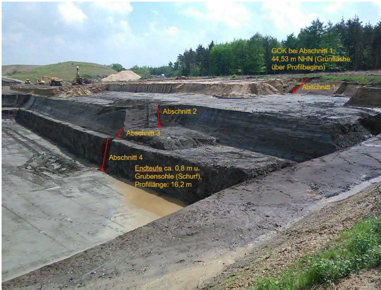
Abbildung 9 Übersichtsdarstellung der Profilaufnahme der Grubenwand Tonabbau Eichenallee
