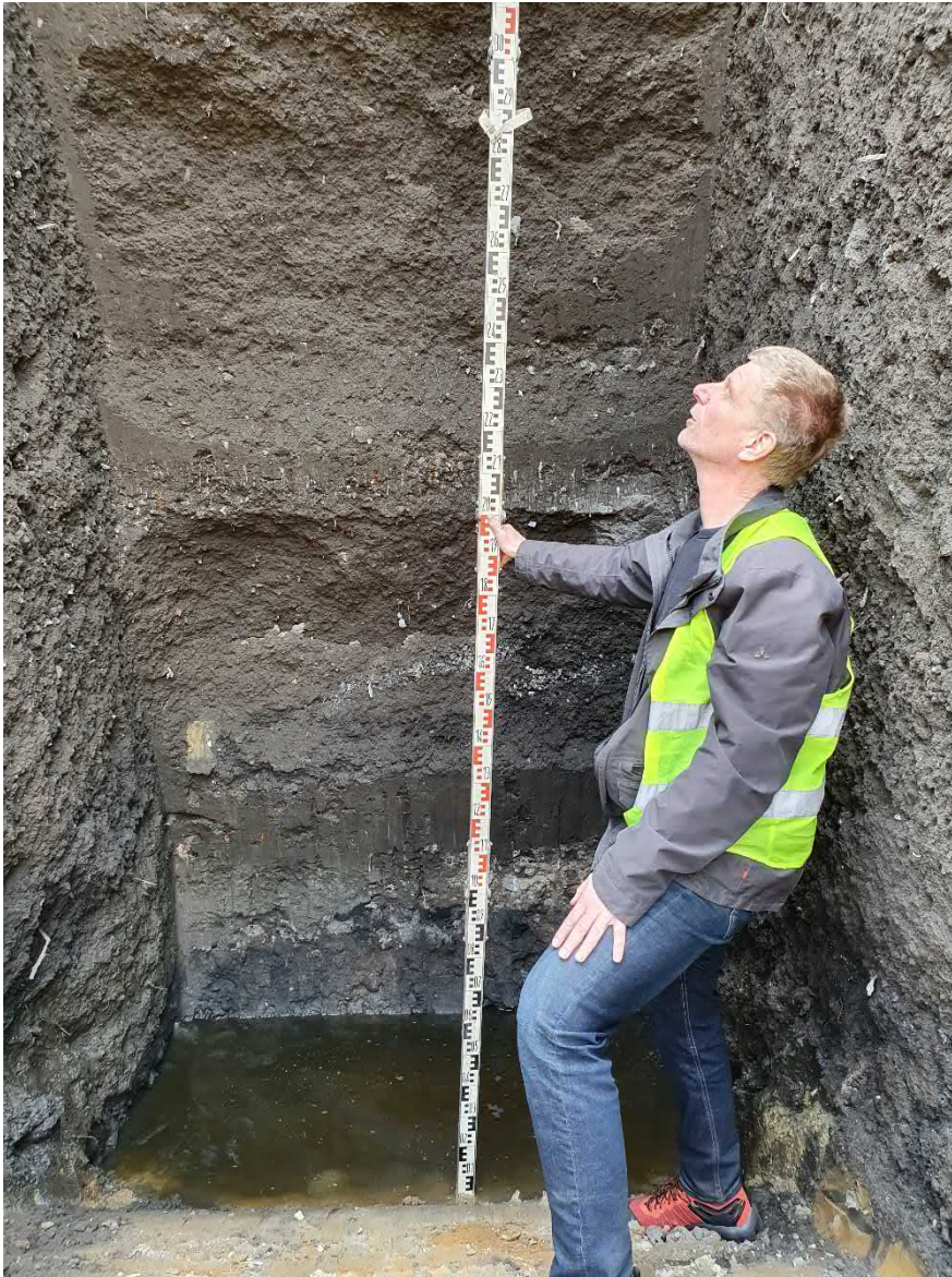
Abb. 4: Schurf 2, Blick nach Osten, Sickerwasser, darüber Hausmüllaschen und Schlacken
