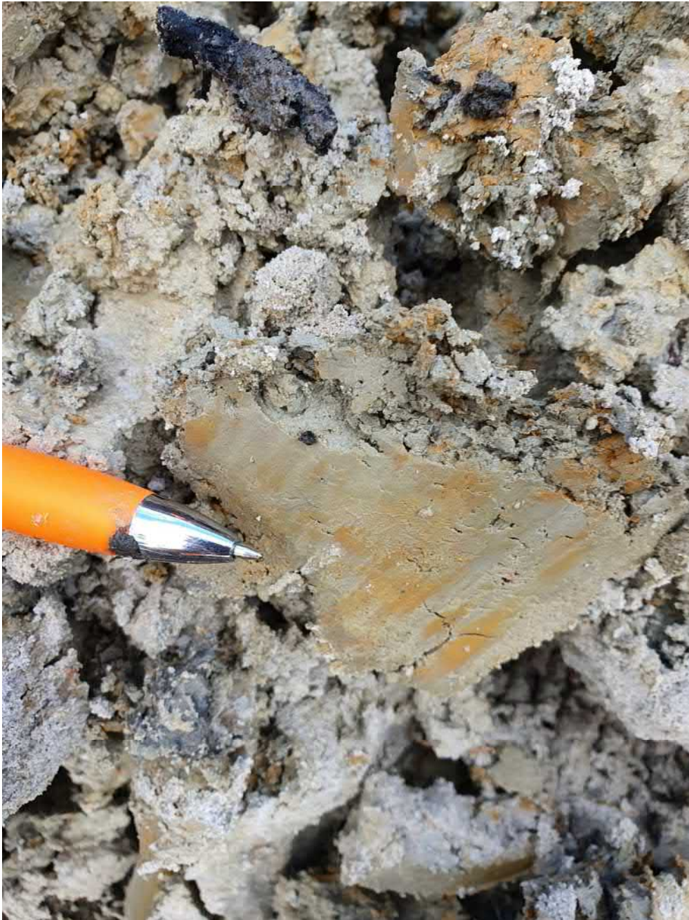
Abb. 8: Geschiebelehm (Detail), orange-gelb-grau marmoriert;
