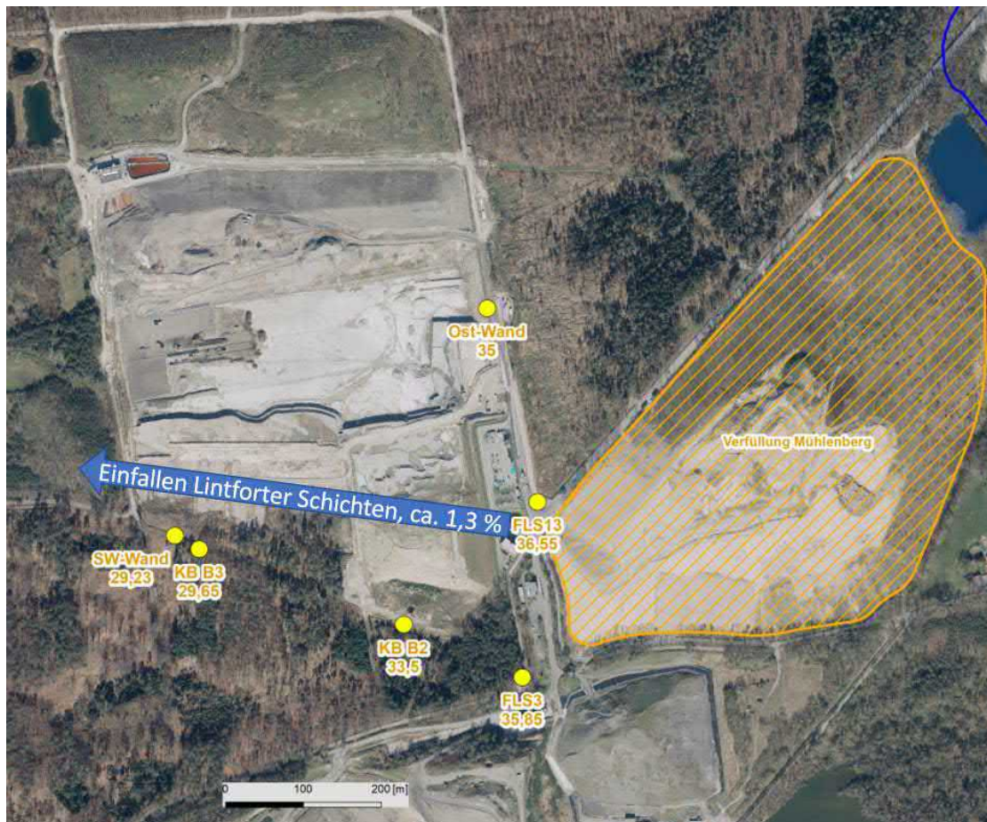
Abbildung 21 Einfallen der Lintforter Schichten westlich der Verfüllung Mühlenberg Zahlenwerte = Höhenlage Oberkante der Mergelschicht [m NHN]
