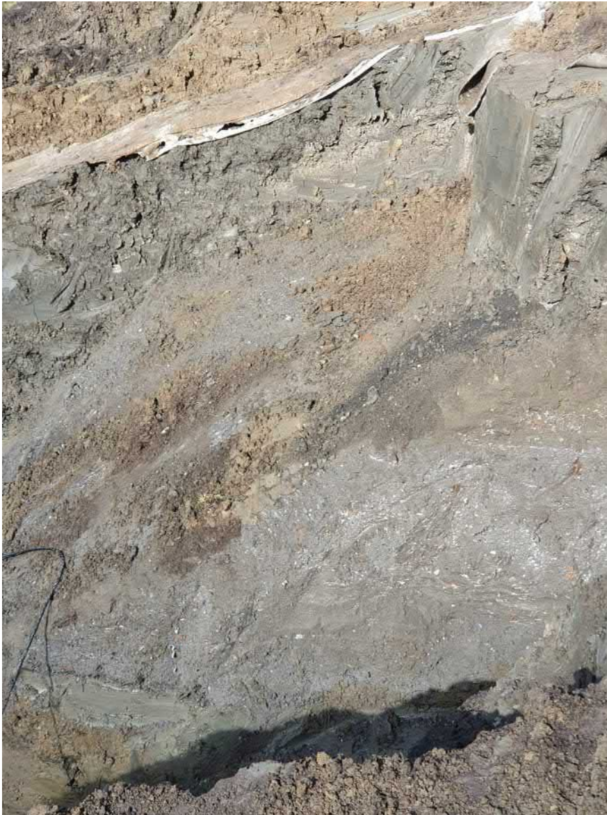
Abb. 5: Auskeilen der Hausmüllverbrennungssasche und Übergang in den Geschiebelehm sowie zur Oberflächenabdichtung (Westseite des Schurfs 5); links die angetroffene und abgerissenen Telefonleitung
