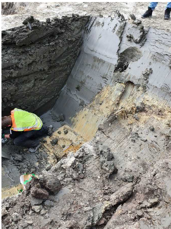
Abb. 5: rechtes Bild: Schurf Ost, Blick nach Westen, Tonkeil nach unten sich verjüngend. linkes Bild: Linse im Geschieblehm, mit Wasser gefüllt (Aufnahme Dr. Kerth)
