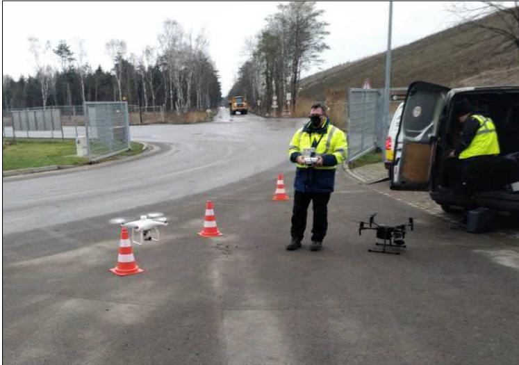
Abbildung 1: Drohnenbefliegung des Mühlenbergs mit einer Wärmebildkamera
