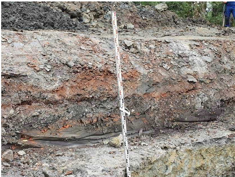
Abb. 4: Schurf 3a Aufgraben des Tonkeils (26.08.2021) außerhalb der Verfüllung: Auffüllung (i.W. Ziegelbruch) im Bereich der Tonbahn Idunahall, darunter Geschiebelehm, rechts Tonkeil grau
