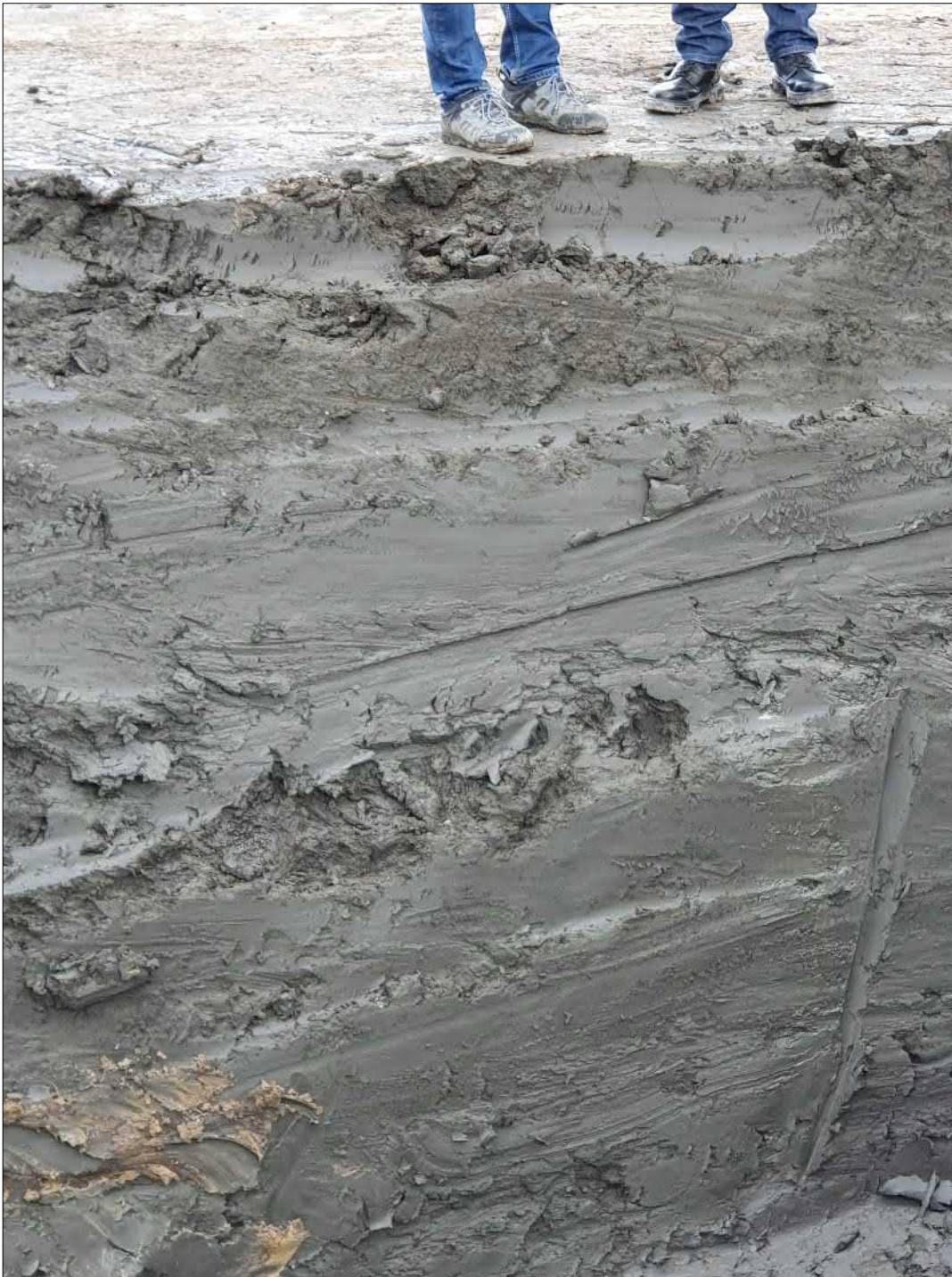
Abb. 6: Feuchte Bereiche innerhalb des Tonkeils
