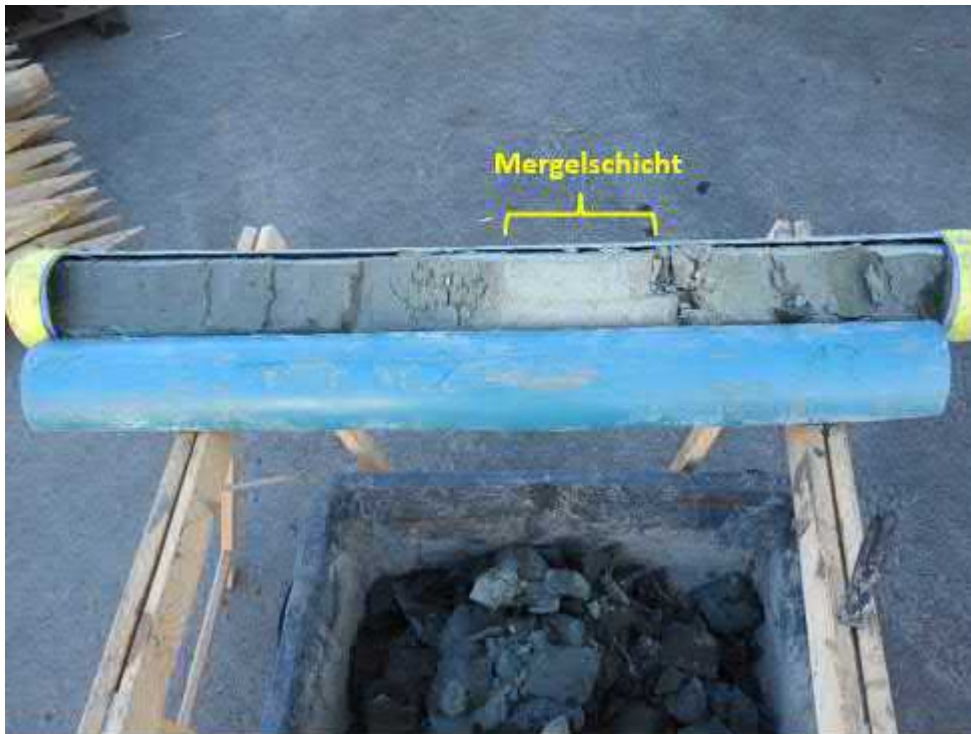
Abbildung 1 Exemplarische Darstellung eines aufgeschnittenen Bohrkerns
