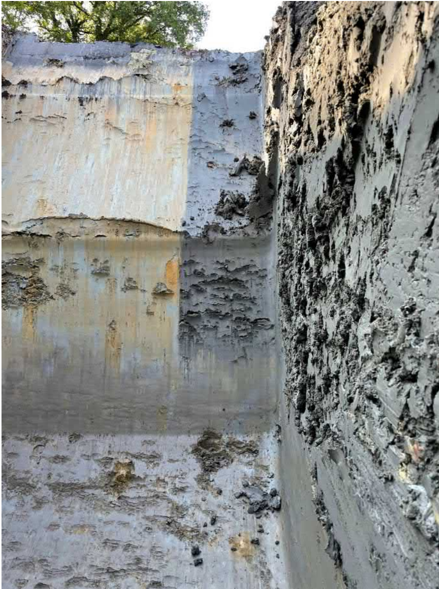
Abb. 3: Schurf 3a, Tonkeil mit Einbindung in den Gesschiebelehm und in die Lintforter Schichten (Foto: Fa. Nottenkämper, 25.08.2021)
