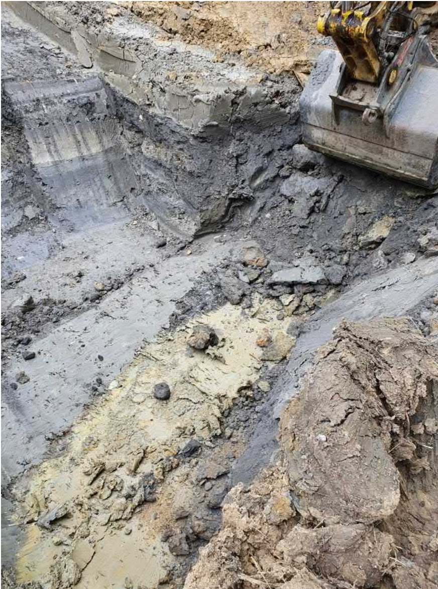
Abb. 5: Schurf 4 Nordansicht; Tonkeil links, rechts Geschiebelehm, abnehmende Breite mit Schlackeneinlagerungen zwischen Geschiebelehm und Tonkeil
