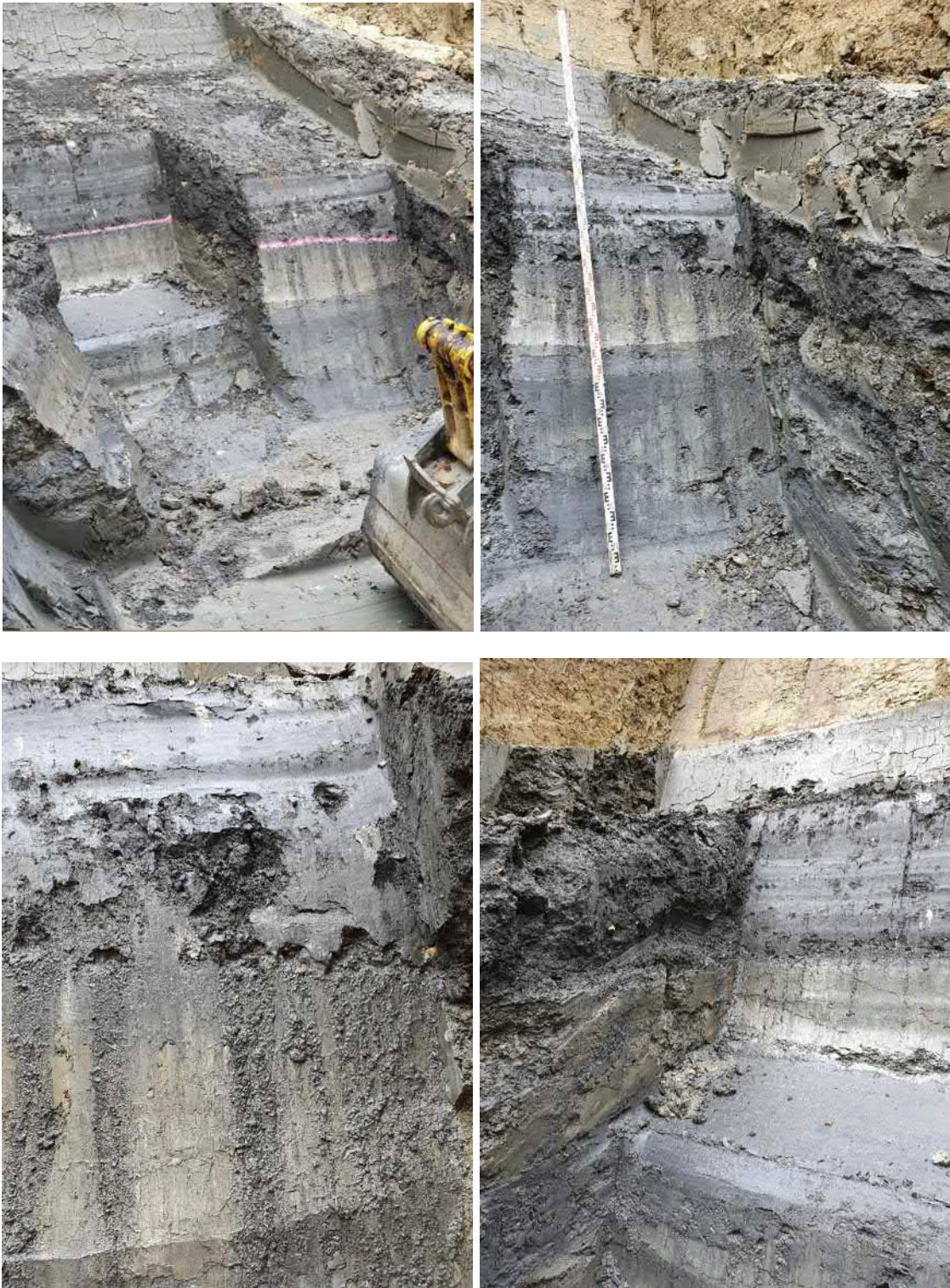
Abb. 6: Grenze zwischen einer Lehmlage, Austritt geringer wahrscheinlich eingeschlossener Restmengen an Sickerwasser in den Schurf (markiert mit rote Sprühfarbe) zu erkennen
