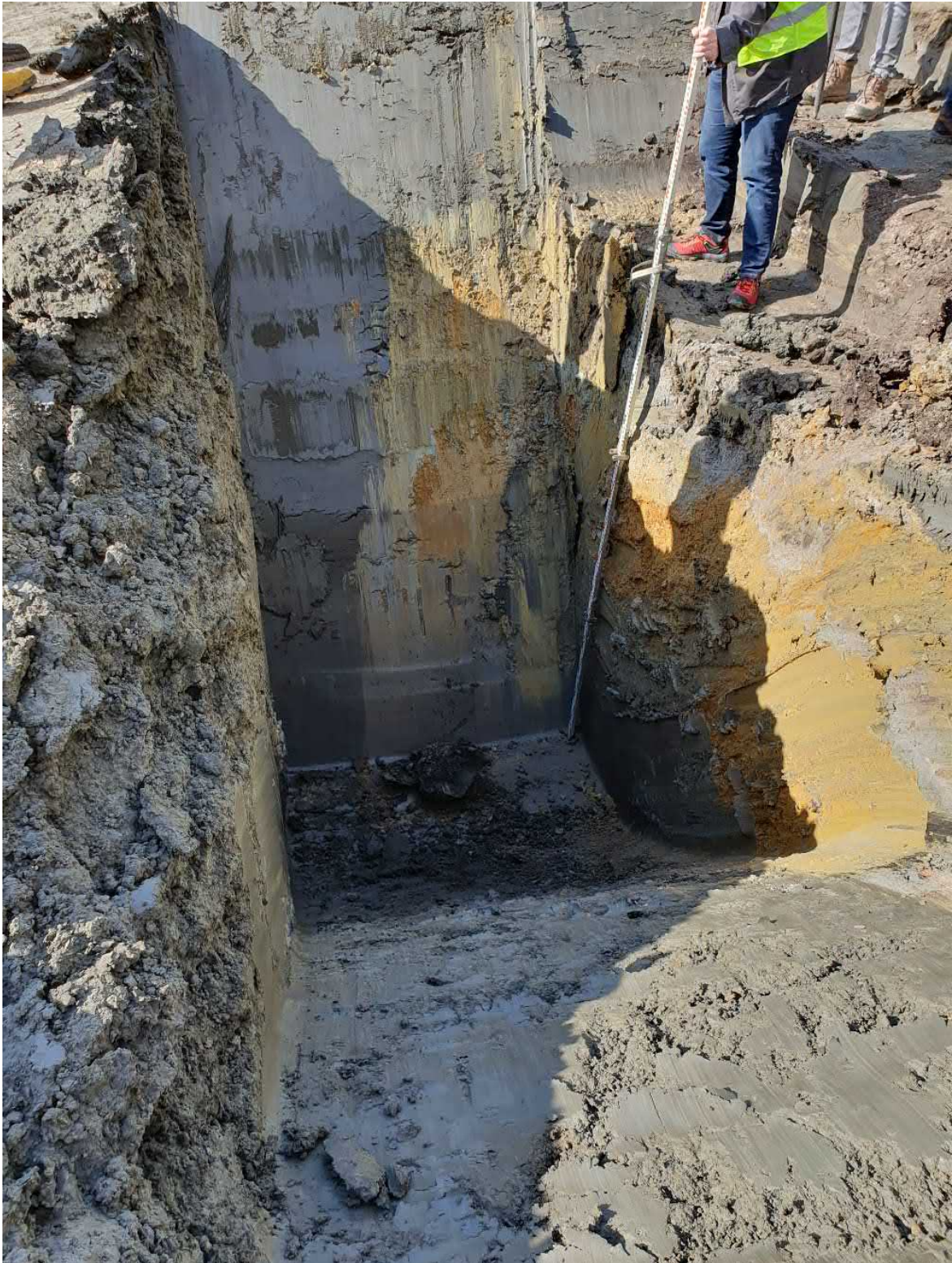
Abb. 7: Tonkeil, Blick nach Süden, nach unten nimmt die Breite ab
