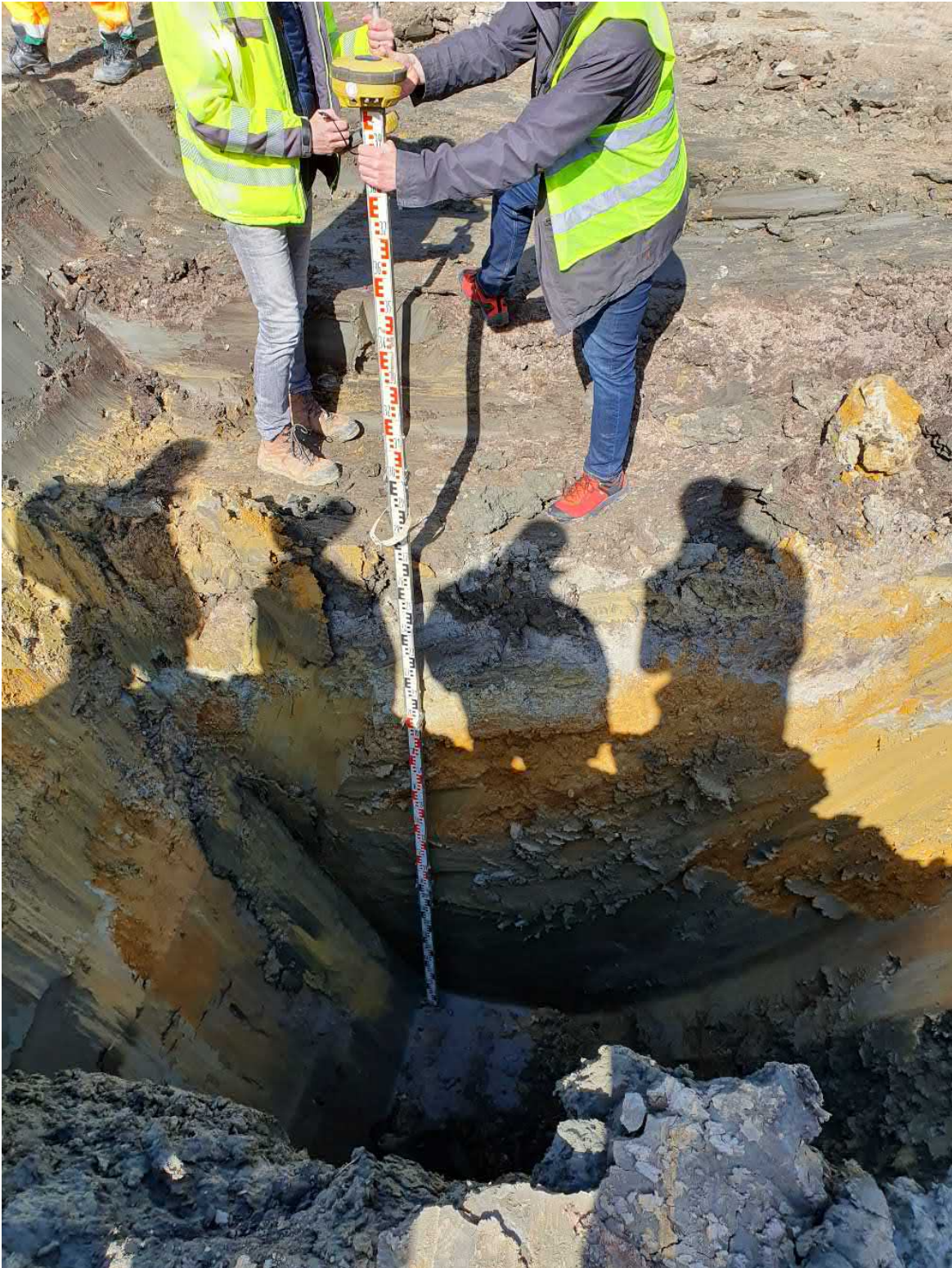
Abb. 8: Schurf westlich des Tonkeils Blick nach Westen; Geschiebelehm (gelb-orange) darunter Lintforter Schichten (Ton braun-grau)
